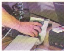
La Spaceball è solo una delle tante interfacce di cui dispone il sistema della Sense8. Utile in fase di esplorazione del mondo virtuale, è uno strumento a 6D: oltre che il controllo del movimento sugli assi X,Y,Z, permette anche di effettuare variazioni di inclinazione e torsione.
